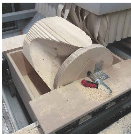
/ Die Außenseiten des Hockers wurden in einer drehbaren Vorrichtung in drei Schritten bearbeitet.
