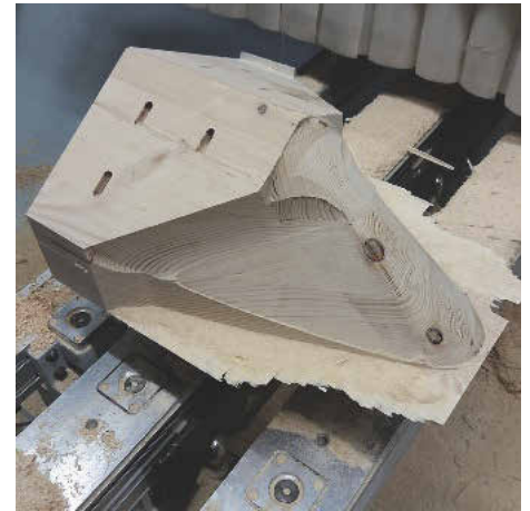
/ Die Innenseiten konnten mit nur einer Aufspannung auf dem BAZ komplett bearbeitet werden.
