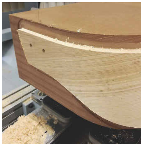
/ Zur Formatierung der formverleimten Rückenlehne wurde eigens eine Vakuumschablone gefertigt, ...
