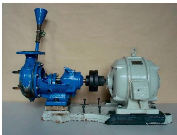
Fundamentpumpe ohne Abdeckung
