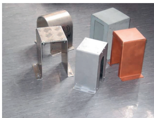
Von Auszubildenden gefertigte Schutzabdeckungen
